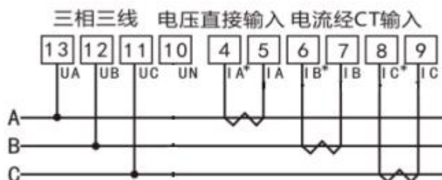
图 5.2、三相三线接线示例图(无 N 相三表法，软件按三相四线模式)
